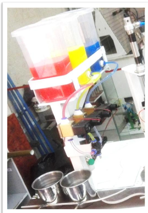
Figura N°02: Sistema de llenado del envase
