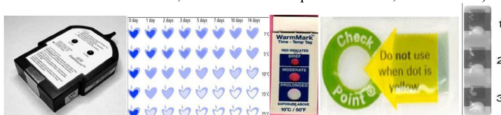
Figura N3.- Ejemplos de indicadores de tiempo y temperatura de izquierda a derecha: DataSource™loggers; Indicador de tiempo y temperatura; MonitorMark™; ChekPoint® Temperatura labels; Vitsab® TTI).
