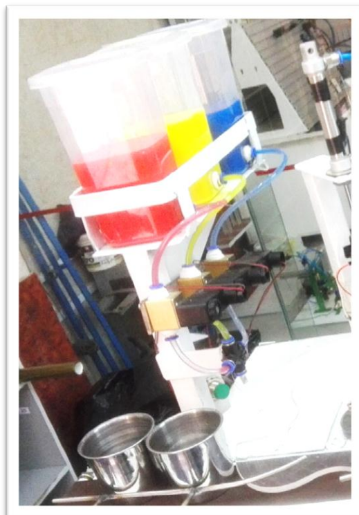
Figura N°02: Sistema de llenado del envase
