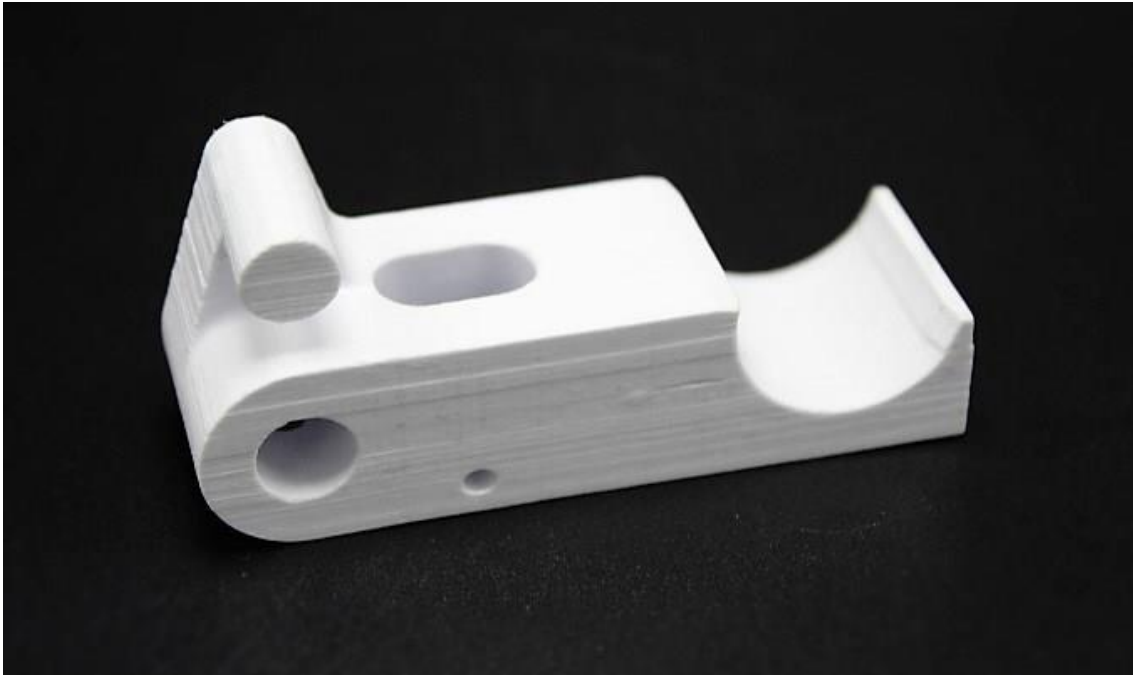
Figura N° 6: Pieza realizada en impresora 3d de laminación de hojas
