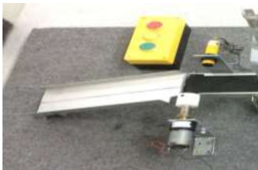
Figura N°11: Contador de cubos
