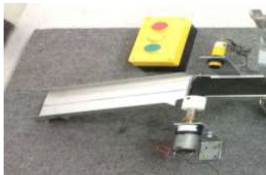
Figura N°11: Contador de cubos
