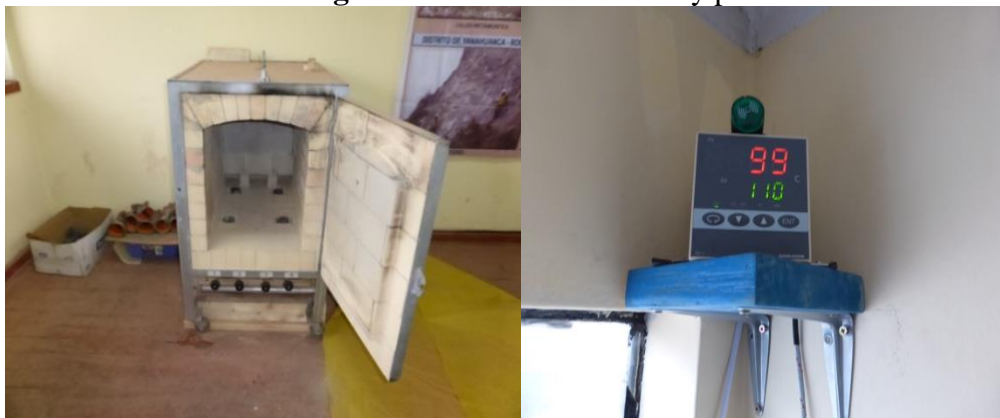
Figura N°2: Horno cerámico y pirómetro
